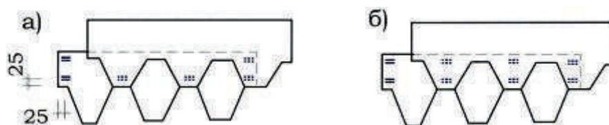
Рисунок 5.5. Схема крепления черепицы “Standart” скобами на кровле с уклоном до 45° (а) и с уклоном более 45° (б).
