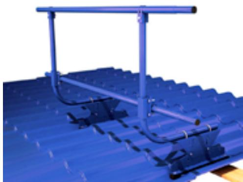
Ограждение с регулируемым углом наклона. Отличается особой прочностью за счет меньшей высоты и геометрии крепежа..Перекладины: две трубы диаметром 25 мм.
