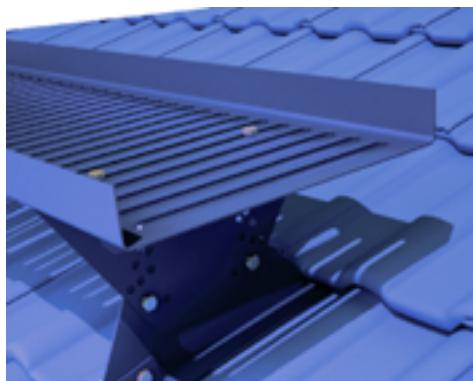
Поверхность мостика обладает особой нескользящей структурой. Длину можно наращивать с помощью стыковочных элементов. Возможно изготовление под заказ от 0,5 до 3 м, шаг 5 см.
