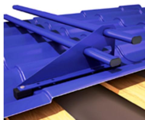
Три отверстия в опоре позволяют регулировать расстояние между покрытием и нижней трубой снегозадержателя в зависимости от угла наклона крыши и особенностей покрытия.
