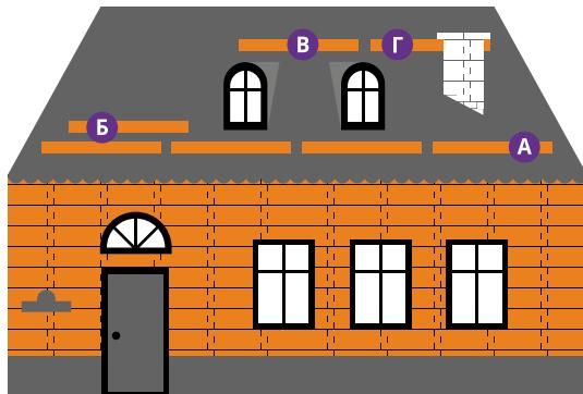
**Снегозадержатели устанавливаются на кровле рядом с карнизом, на уровне несущей стены**
