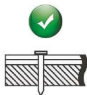
Рис. 2 Пример правильной забивки гвоздей при монтаже продукции.
